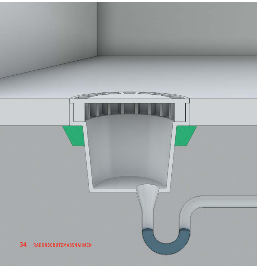
Abb. 7.7: Abdichten eines Bodenablaufs
