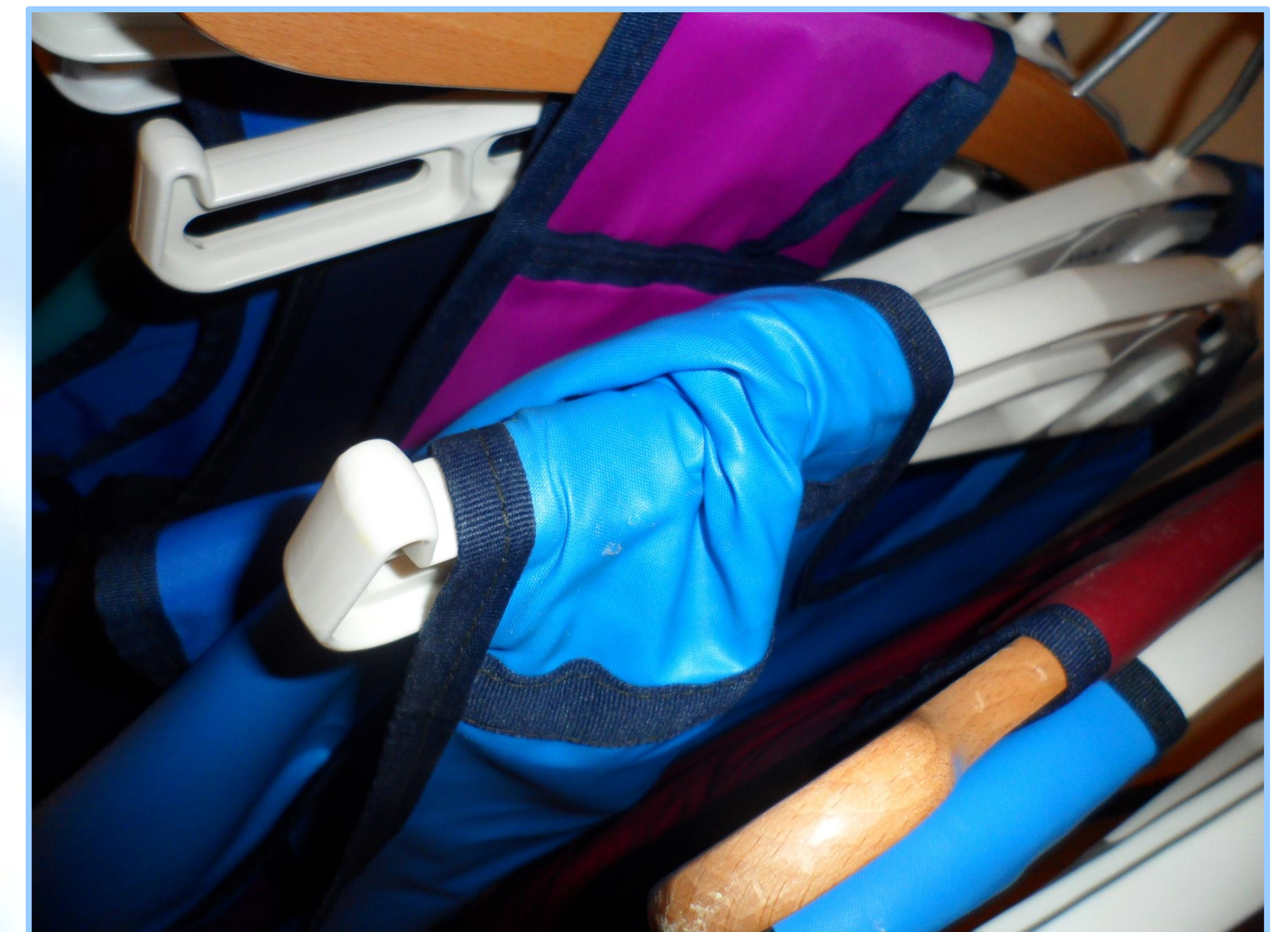
Ungeeignete Aufbewahrung einer Strahlenschutzschürze
