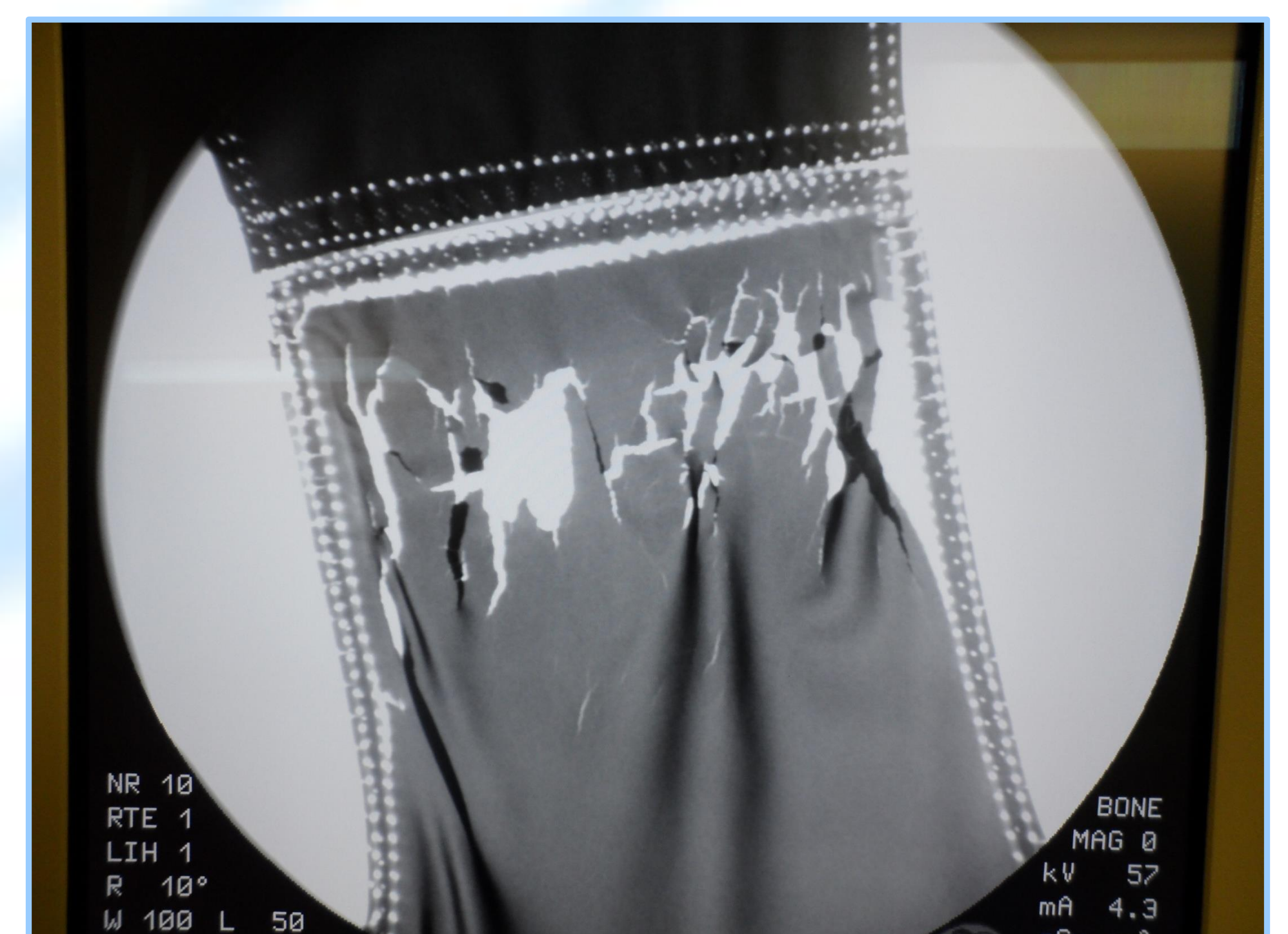
Schaden an einer Schürze bei ungeeigneter Aufbewahrung
